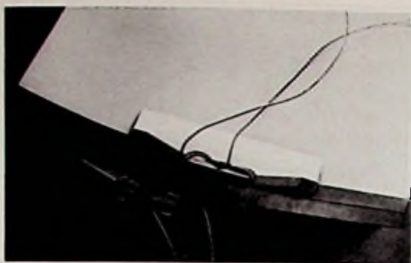
Bild 9: Der PCM-Kopf sitzt unter dem Videokopf, allerdings um 33 Spurbreiten (= 746 µm) versetzt, um den Umschlingungswinkel des Bandes um die Videokopffrommel beibehalten zu können
