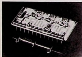
Bild 1: Gesteuerter Oszillator mit OFW-Filter (rechts vorne) für schnurlose Telefone (Siemens-Pressbild)
