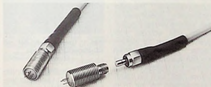
Bild 1: Optisches Digitalübertragungssystem für 10 Mbit/s (Hirschmann-Pressbild)
