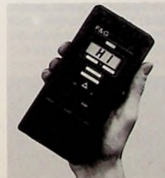
Bild 1: Ebenso handlich wie der dazugehörige Empfänger: der optische Pegelsender OPS-5 von F & G (PKI-Pressbild)
