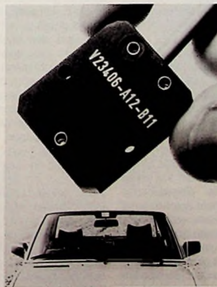
Bild 1: Magnetsonde registriert den Winkel zum Erdmagnetfeld (Siemens-Pressbild)
